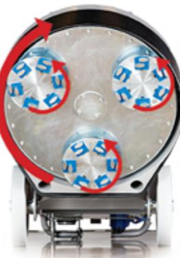
Figur 4-1 Illustrerar hur slipskivorna rör sig i förhållande till sliphuvudet.
